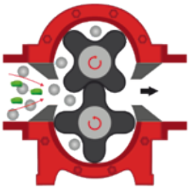
Injection S: segmenti simmetrici del corpo pompa con design InjectionSystem, disposti sui lati di mandata e aspirazione
