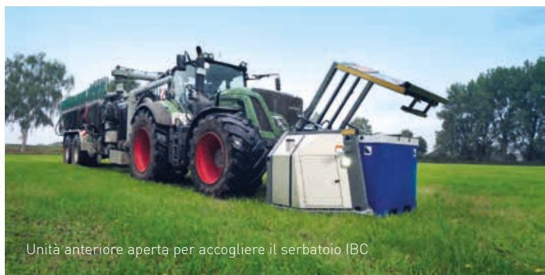
Unità di miscelazione: il liquame e l'acido si mescolano insieme
