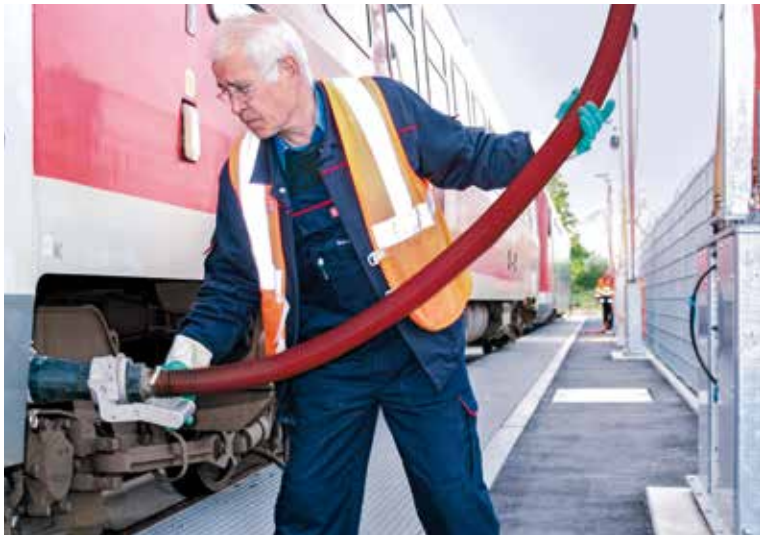
Las TUnit de Vogelsang son equipos especialmente compactos, con un sistema automático de recogida de mangueras que facilita el trabajo del personal de servicio.
