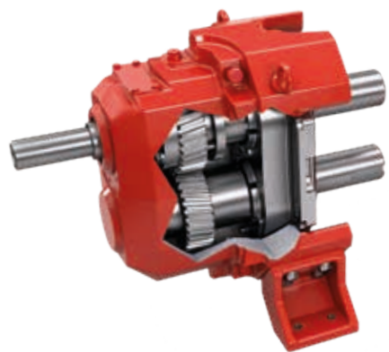
Schrägverzahnte Zahnräder an den Antriebswellen von Drehkolbenpumpen der EP-Serie garantieren eine nie dagewesene Laufruhe und geringe Vibration.
