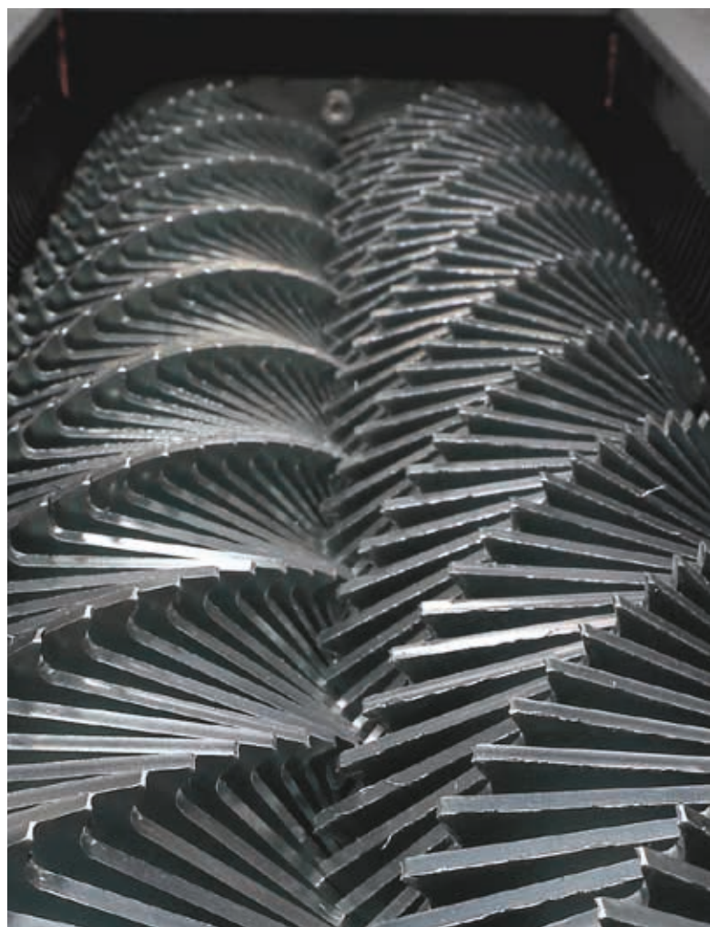
I rotori Ripper monolitici sono estremamente robusti e particolarmente facili da sostituire
